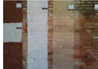
Prove tecniche prima dell'applicazione delle boiacche in alcuni saloni del Complesso Gallerie dell'Accademia a Venezia
